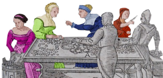
Agricola, De Re metallica, 1556 : le tri du minerai
